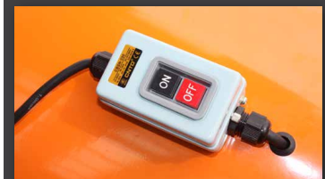
Boîtier électrique de mise en service
