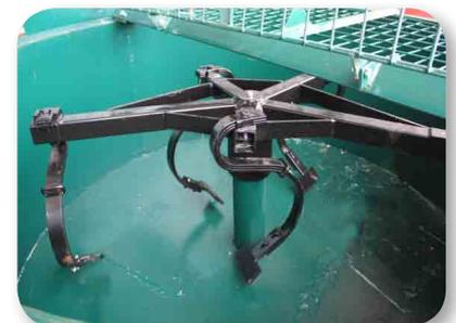
Racloir monté sur système de ressort
