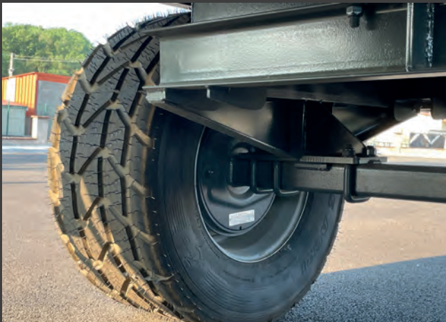
Fixation de l'essieu par bride
