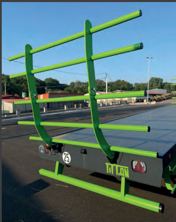
Echelle arrière réglable pour accueillir différents chargements
