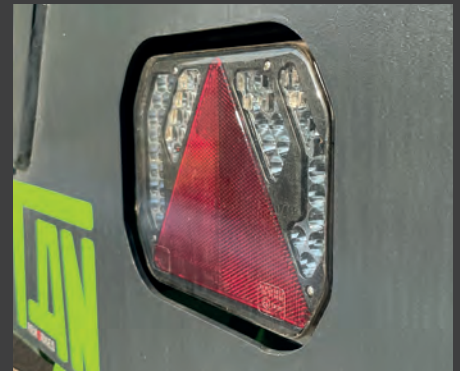
Éclairage arrière encastré
