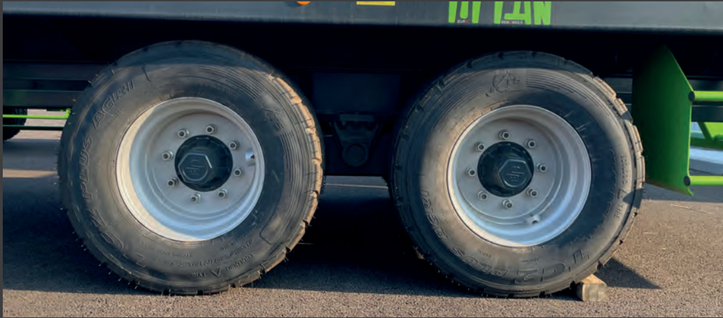
Essieu balancier arrière avec roue 435/50 - R19,5
