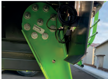
Détail de la fixation de la barre anti-encastrement
