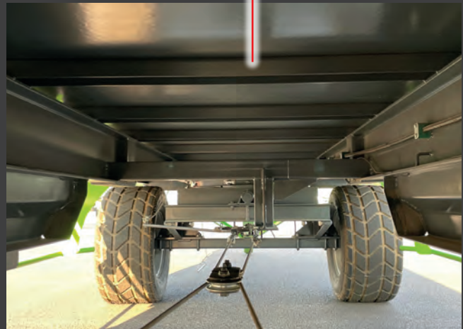
Essieu avant 8008FF 350x60 / 8 trous, fixé par bride sur tourelle avant sur roulement à billes 30 tonnes
