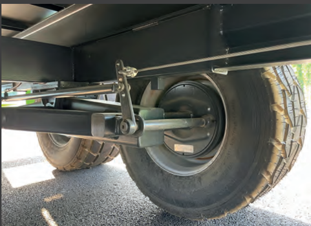
Vue intérieure essieu-balancier
