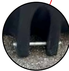
6 fixations en bas pour immobiliser la cuve sur un camion ou une remorque
